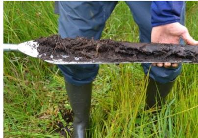
**Figure 15 : Prélèvement de tourbe à l'aide d'un carottier russe dans le cadre d'un pré-diagnostic fonctionnel.**
